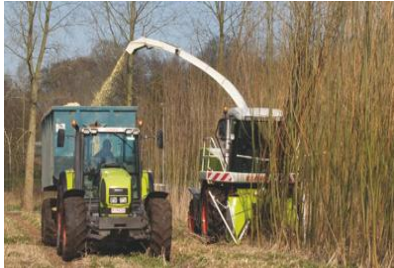
Mäh-Häcksler: Fällen und Hacken des Holzes Einblasen auf Container
